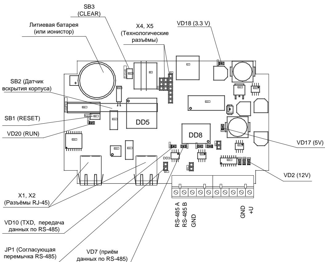
Рисунок 2. Схема расположения элементов КСК (аппаратная версия 2.1)
